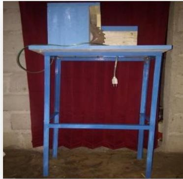
**Gambar 1.** *APPS (Alat Pemotong dan Pengerat Stek Batang Singkong)*
